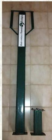
Aparato para clavar estacas de madera
