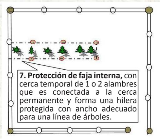
**7. Protección de faja interna,** con cerca temporal de 1 o 2 alambres que es conectada a la cerca permanente y forma una hilera protegida con ancho adecuado para una línea de árboles.
