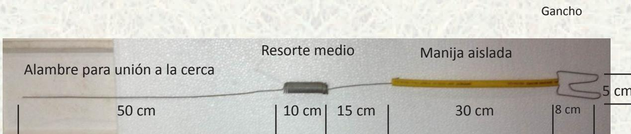
**Detalles de la instalación de la llave interruptora**
